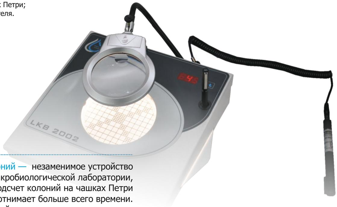
**Счетчик колоний** — незаменимое устройство для любой микробиологической лаборатории, поскольку подсчет колоний на чашках Петри отнимает больше всего времени. Удобный в использовании счетчик для быстрого и точного подсчета.
