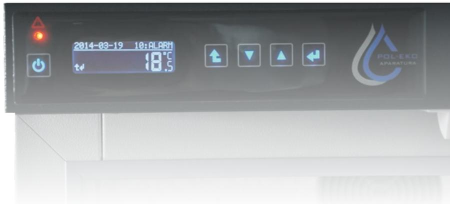
Изделия версий **BASIC, COMFORT, PREMIUM** оснащены микропроцессорным PID-контроллером с графическим ЖК-дисплеем и сенсорной клавиатурой с подсветкой.
