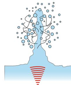
В ультразвуковом увлажнителе используются пьезоэлектрические генераторы, преобразующие электрическую энергию в механическую энергию вибраций. Генераторы, погруженные в деионизированную воду, распыляют ее на мельчайшие капли, которые равномерно распределяются по камере.
