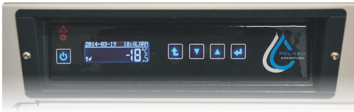
Изделия исполнений COMFORT и PREMIUM оснащены микропроцессорным PID-контроллером с графическим ЖК-дисплеем и сенсорной клавиатурой с подсветкой.
