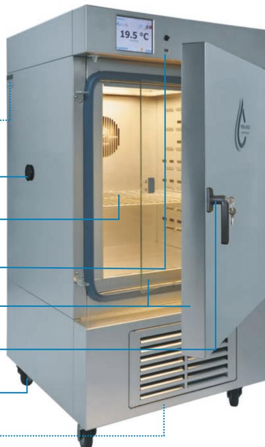
Климатические камеры оснащены микропроцессорным PID-контроллером температуры и влажности (опционально — освещенности, опция — \*/FIT) с большим (5,7") полноцветным сенсорным экраном, интуитивно понятным меню и удобным программным обеспечением. Одним из важнейших преимуществ является возможность подключения к сети Ethernet для удаленного управления с любого компьютера. Климатические камеры поставляются исключительно в исполнении TOP+.
