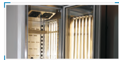
FIT DS — Климатические камеры с лампами в дверце и на боковых стенках
